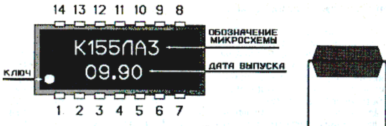
Рис. 5. Конструктивное исполнение интегральной схемы.
